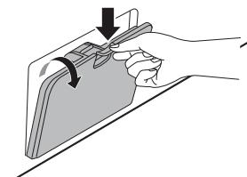
**3** Najskôr odstráňte odtokový uzáver z odtokovej hadice **1** a potom vypustte vodu. Potom pomaly odskrutkujte filter odtokového čerpadla **2** a vypustte zvyšnú vodu a potom z filtra odstráňte všetky zvyšky alebo predmety.
